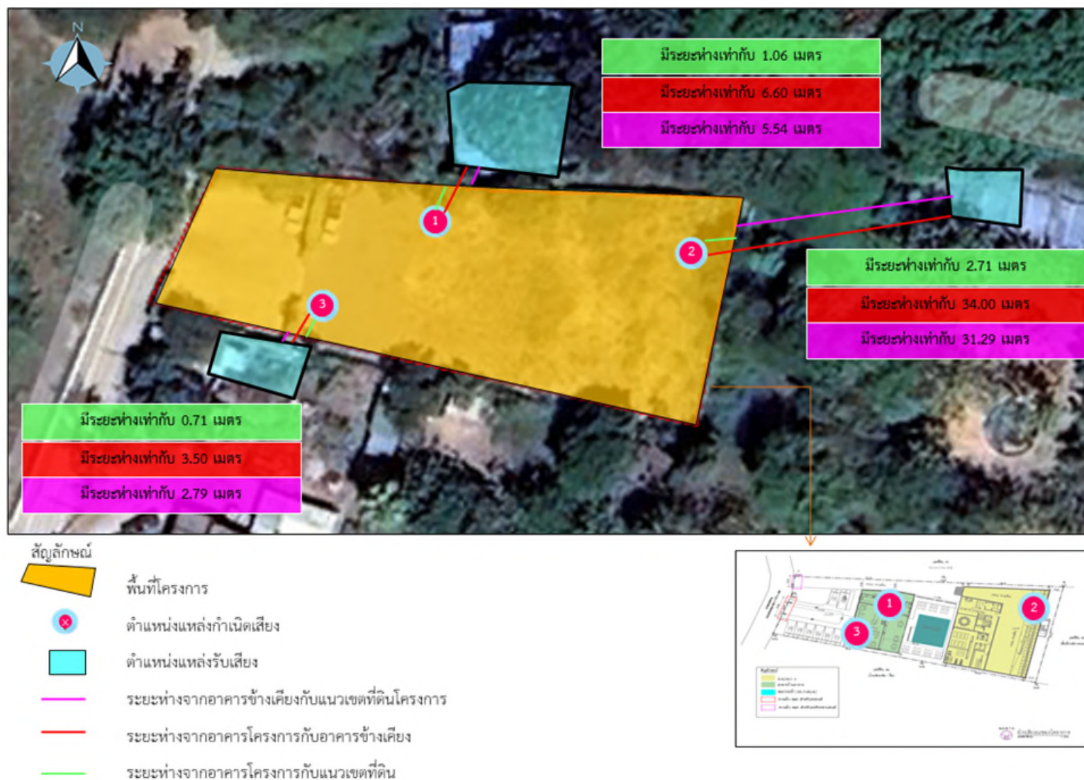
รูปที่ 4.1.5-1 ระยะห่างจริงจากแหล่งกำเนิดเสียงไปยังแหล่งรับเสียง
