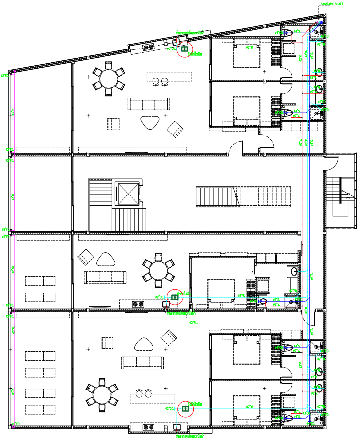
แปลนพื้นระบบสุขาภิบาล น้ำทิ้ง น้ำเสีย ชั้น 2 Scale: 1:125
